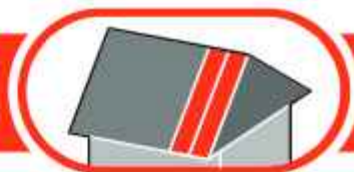
7b nachylenie połaci dachu powyżej 20 stopni deskowanie ażurowe (deska co 10 cm)
